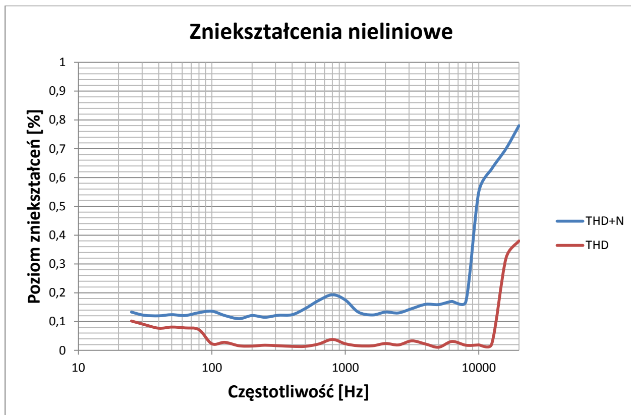
Rys. 19. Charakterystyka współczynnika zniekształceń nieliniowych w korelacji z pasmem częstotliwościowym. Osobny pomiar przeprowadzony dla współczynnika zniekształceń harmoniczných (THD) oraz dla współczynnika zniekształceń harmoniczných ze składową szumów
